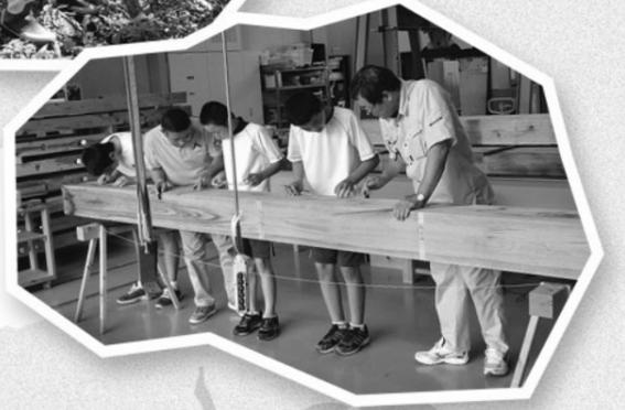
製材品の割れ長さ測定作業
