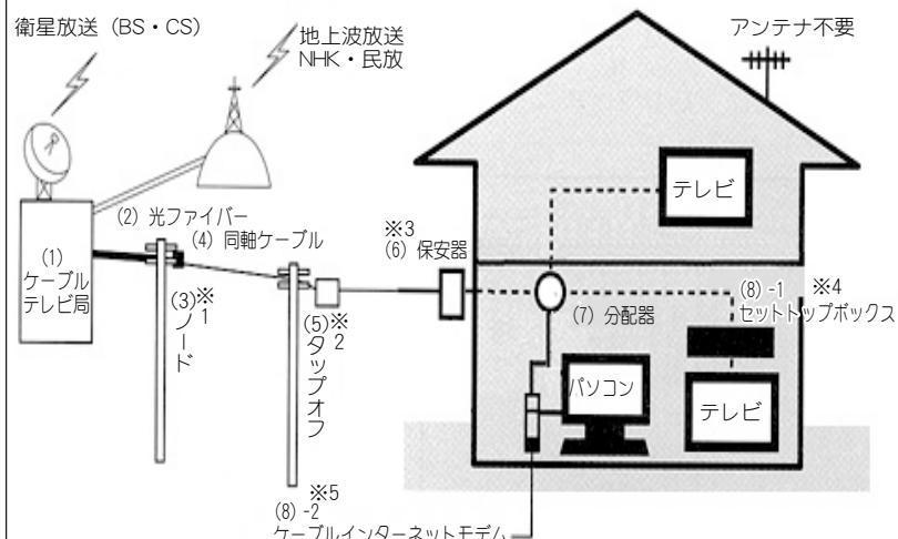
※1 光ファイバーから同軸ケーブルへ光を電気信号に変える変換器
