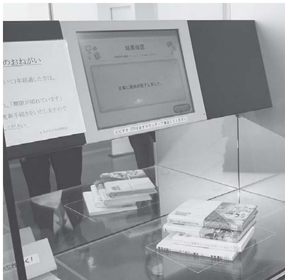
専用机に置けば、受付に行かなくてもICタグでまとめて貸出もできる
