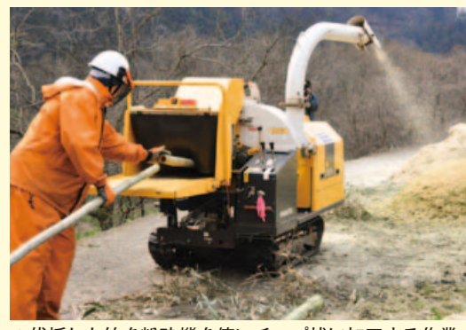
▲伐採した竹を粉碎機を使いチップ状に加工する作業
