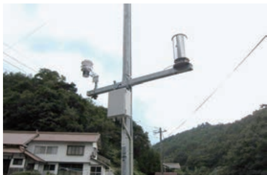
■向かって右側が雨量計、左側がその他の気象観測装置
