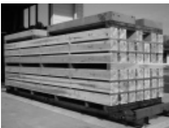
柱材の人工乾燥試験(蒸気式乾燥機)
