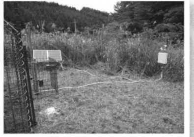
Webカメラを装備した捕獲装置
