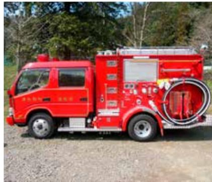
津和野町消防団総合整備計画に則り、水槽付消防ポンプ自動車（通称タンク車）を津和野町消防団第一分団に新たに配備します。このタンク車は消火用のタンクを搭載しており、現場に到着した際に素早く消火活動に入ることができま
