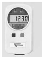
家庭用コンセントに挿している器具の電気使用量・待機時消費電力等がワット (W)、電気料金、二酸化炭素排出量で表示されるので、上手に省エネを行うことができます。
