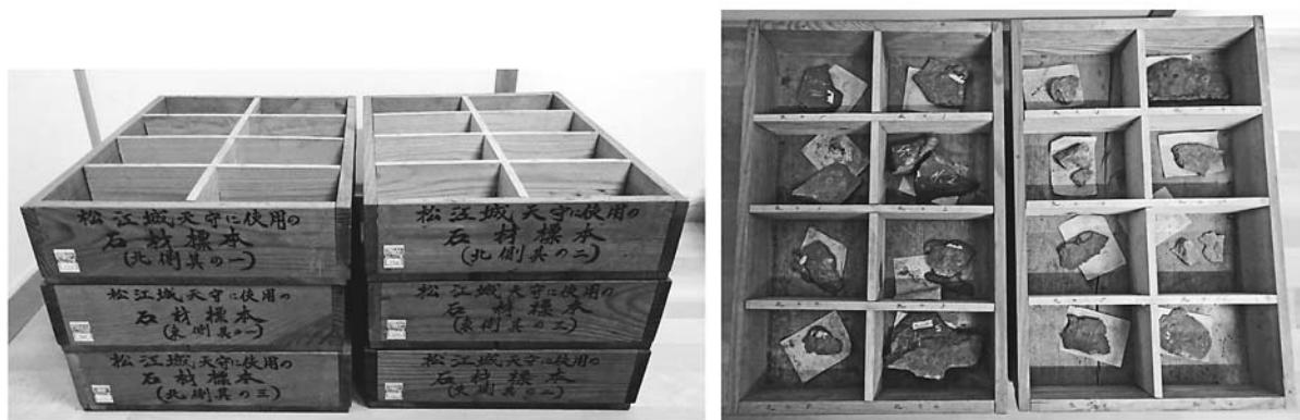
図2 松江歴史館に保管されている昭和25年～30年の天守大修理時に採取された天守台北側面と東側面の石。
