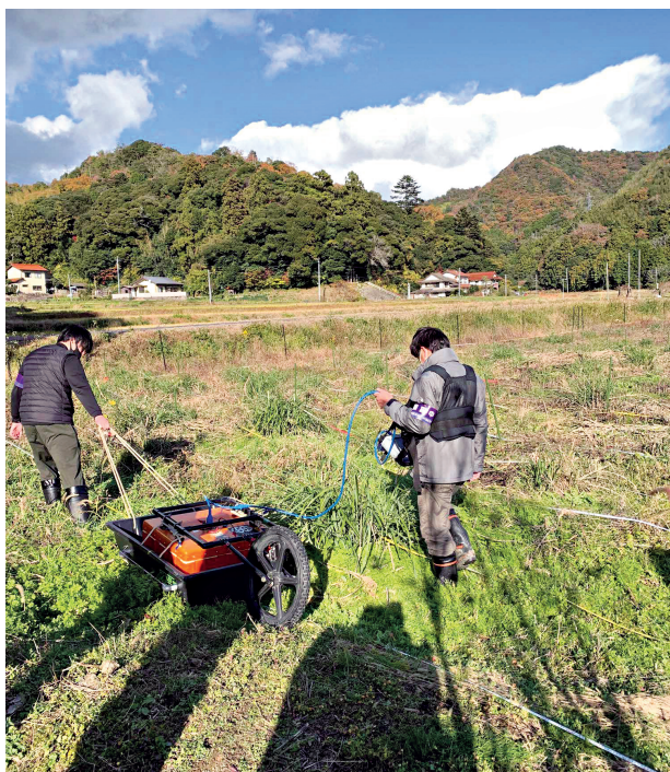
写真3 平ノ前廃寺 地中レーダー探査実施の状況 2021年11月
